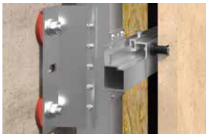
A SystemOne homlokzati rendszer keresztmetszete terméskő panellal
