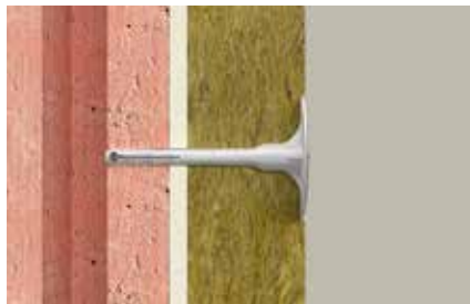
Ásványgyapot rögzítése téglafalhoz
