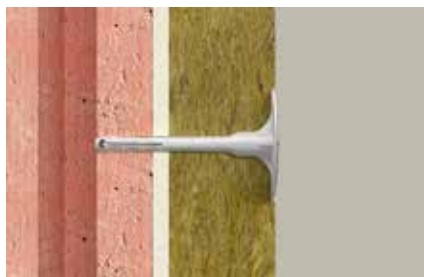
Ásványgyapot rögzítése téglafalhoz
