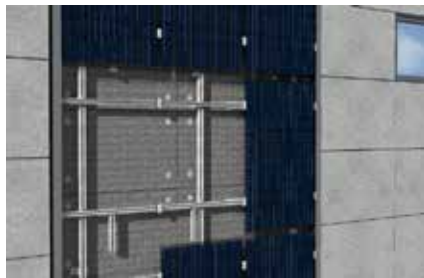
A tartószerkezet bordái és keresztartói
